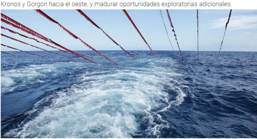
El procedimiento de adquisición de sísmica en el mar genera imágenes del subsuelo
