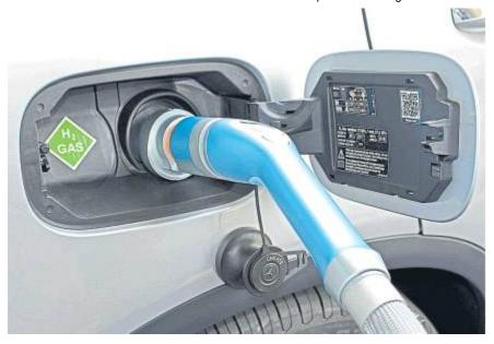
Con celdas de combustible se almacena hidrógeno en los vehículos.
