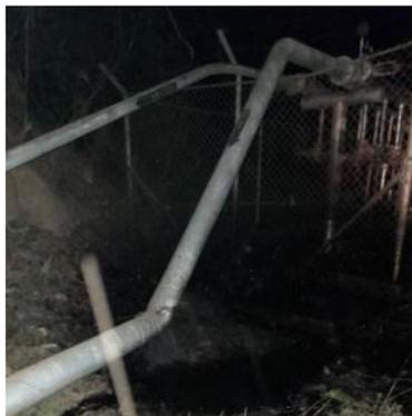
"El primer evento causó daño en la línea de transferencia de agua-crudo ocasionando derrame de producto y el segundo evento se registró en la línea que va desde la Planta de Inyección de Agua, PIA 3, hasta la Planta de Inyección de Agua PIA 5. En este último se produjeron abolladuras en la tubería", señala el comunicado.
