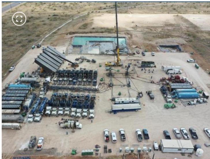
Imagen 4: Disposición y distribución de los equipos para el trabajo en el pozo. FOTO:EL TIEMPO
